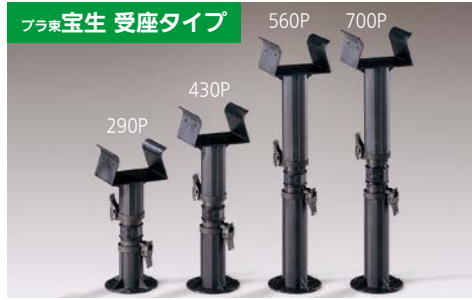
【クビ】プラ束宝生 受座タイプ （木造軸組工法の場合）プラ束間隔・大引き間隔 1000mm以内
